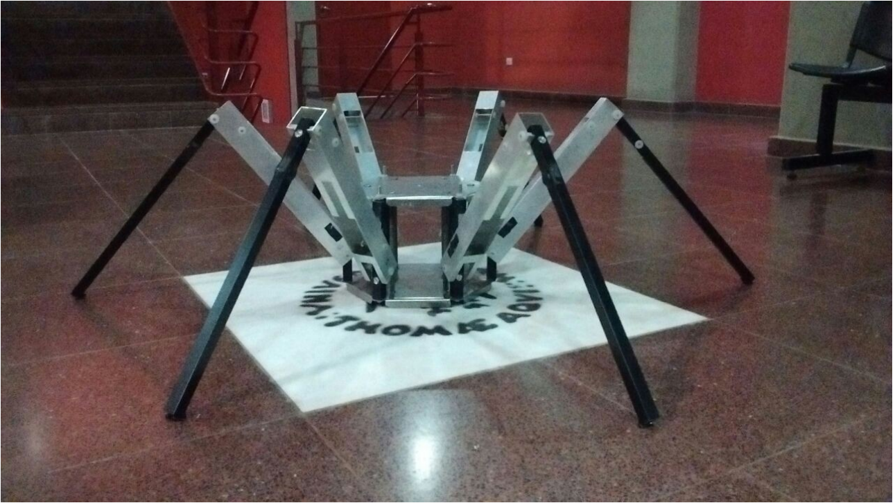
Estructura del robot, antes del montaje de actuadores, sensores y unidades de control.
